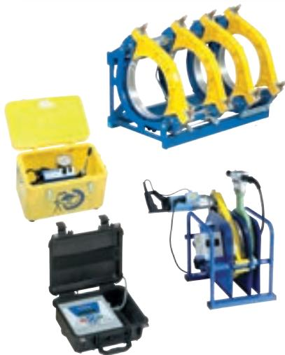
Аппараты PROTOFUSE это аппараты с ручным управлением сваркой, совмещенные с блоком протоколирования. Данный блок «направляет» оператора в соответствии с международными стандартами сварки и записывает сварочные циклы такие как: функция обратного отслеживания, температура нагревательного элемента, время и давление для каждой фазы цикла.
