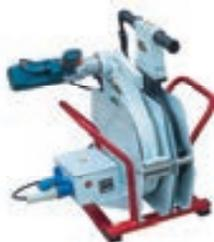
Аппараты оснащены гидравлическим блоком управления типа ЧПУ, который обеспечивает интегральное управление процессом сварки в соответствии с международными стандартами и учитывает тип ПЭ, диаметр и толщину трубы. Аппарат обладает функцией полного обратного отслеживания: сварочный цикл, оператор, местоположение и труба. Все данные доступны для выгрузки через встроенный USB порт.
