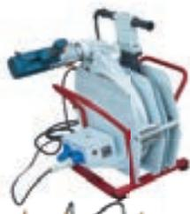
Аппараты это аппараты с ручным управлением сваркой, совмещенные с блоком протоколирования. Данный блок «направляет» оператора в соответствии с международными стандартами сварки и записывает сварочные циклы такие как: функция обратного отслеживания, температура нагревательного элемента, время и давление для каждой фазы цикла.
