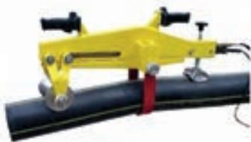
Трубы из ПНД небольшого диаметра часто хранятся на барабанах или в бухтах и поэтому имеют тенденцию к искривлению и овальности. Следовательно, перед соединением концы труб необходимо выпрямить и избавить от овальности. Crocoplast - идеальный инструмент для этой цели. Он поставляется с гидравлическим блоком, который делает операции по правке и скруглению труб быстрыми и легкими.
