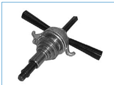
Рис. 9. Вороток для прорезания отверстий в ПЭ трубе.
